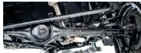
**On- & Offroad** :Die Kombi aus Starrachse und Einzelradaufhängung verbindet das Beste aus beiden Welten.
