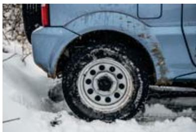
**So muss es sein:** Hinten packt der Jimny dank kurzem Überhang sogar einen 46-Grad-Winkel.
