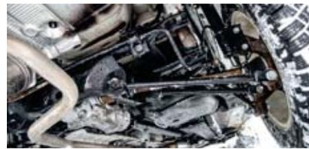
**Filigrane Technik:** Der Duster ist mit Einzelradaufhängung ausgestattet – offroad eine Schwachstelle.
