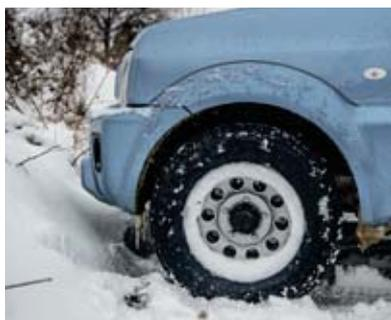
**Dank kurzer Überhänge:** Ein Böschungswinkel von 37 Grad vorn geht absolut in Ordnung.
