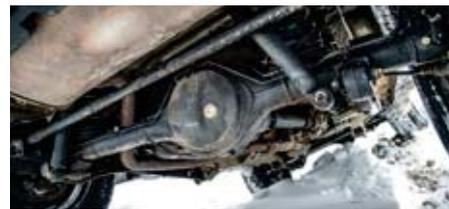
**Robuste Technik:** Dank Starrachsen hält der Jimny im Gelände einiges aus und verschränkt recht gut.
